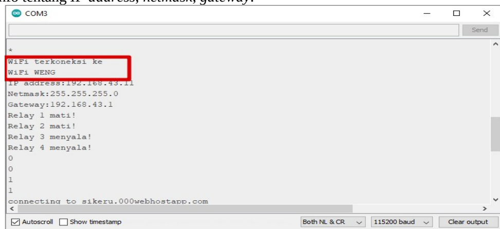
Gambar 11 Hasil Pengujian koneksi NodeMCU ke WiFi
